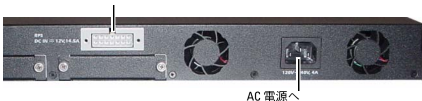
図 1-15. スイッチとの AC/DC 電源接続
